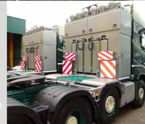
▶ RVS kistenwand inclusief 1200 liter brandstoftank
