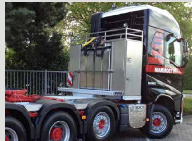
▶ RVS kistenwand inclusief 900 liter brandstoftank
